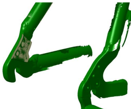
3D Scan Rahmenendstück inkl. rückgeführter Anbindungsflächen
