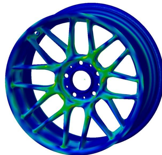
FEM Berechnung (Statische Spannungen bei Biegeumlaufbelastung nach ISO 3006: 2005)
