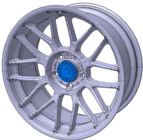
CAD Modell der Felge mit konstruierter Abdeckung (CATIA V5)
