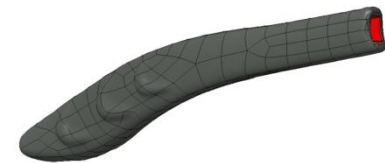
Gespiegeltes und nach- gearbeitetes CAD Modell zur Ersatzteilbestellung
