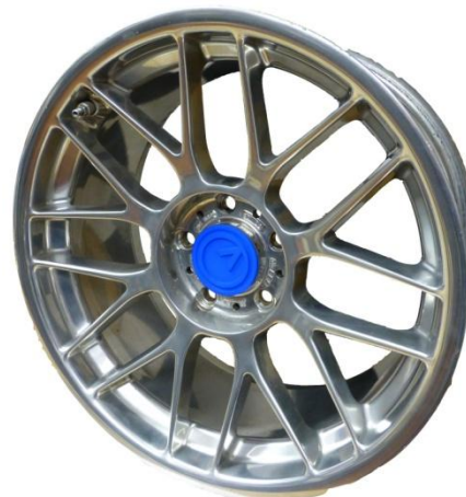
Reale Felge mit RP Bauteil der Abdeckung
